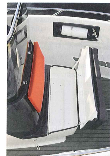
Pulpetin sisäosat on käytetty hyvin hyödyksi. Penkin alla tilaa on paljon, mutta pulpetin sisällä vielä enemmän. Tila avautuu viisaasti eteen, joten tiloja on helppo käyttää. Vasemmalla häämötävä kylmäarkku on lisävaruste, mutta laadukas sellainen.
