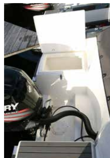
Test med nya Mercury F100EFI. Tyvärr något för klen hydraulstyrning till denna 100-hästare. Ett stort plus däremot för de båda plattformarna (och ankarboxarna) på respektive sida om motorn.
